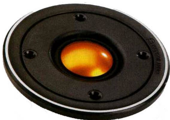
Il tweeter ha la membrana rigida dal caratteristico colore bronzo dovuto ai particolari trattamenti che ne innalzano la rigidità e la leggerezza. Notare il piccolo ma potente complesso magnetico.
